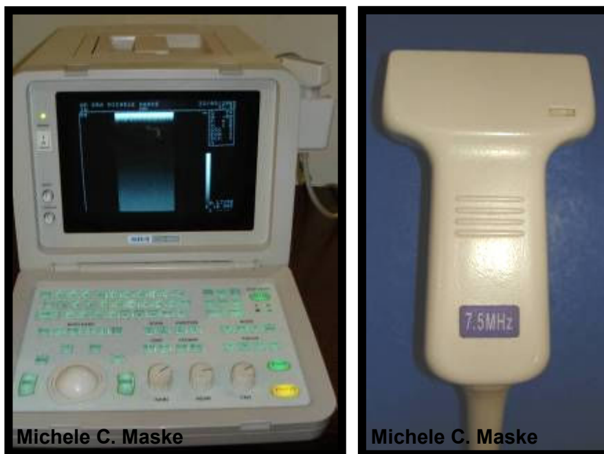
FIGURA 3 – Aparelho de ultrassom SIUI 485-V com transdutor linear multifrequencial de 7,5 a 10 MHz.
